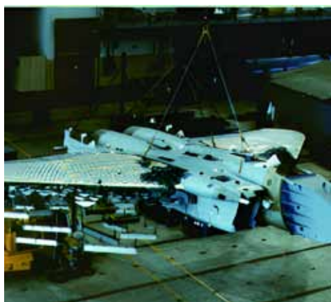
Акустическая эмиссия в процессе испытаний на усталость полноразмерного истребителя
