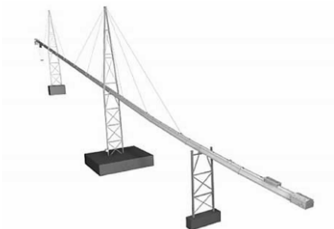
Рис. 12. Транспортер Vecobelt на воздушной подушке
