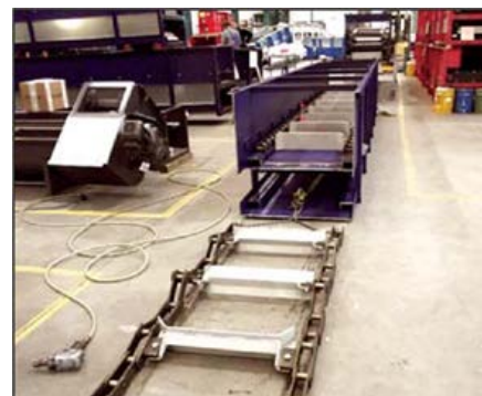
Процесс сборки скребкового конвейера
