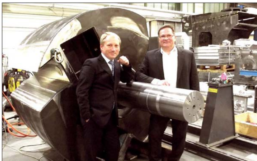
Ротор рубильной машины диаметром 1,8 м в цехе сборки
