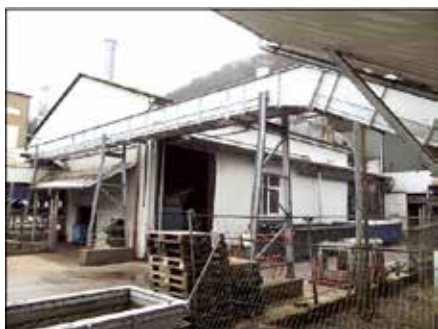
Скребковый транспортер, в свою очередь, перемещает щепу к рубительной машине
