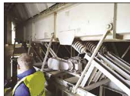
Вибротранспортер на выходе из автоматизированного склада
