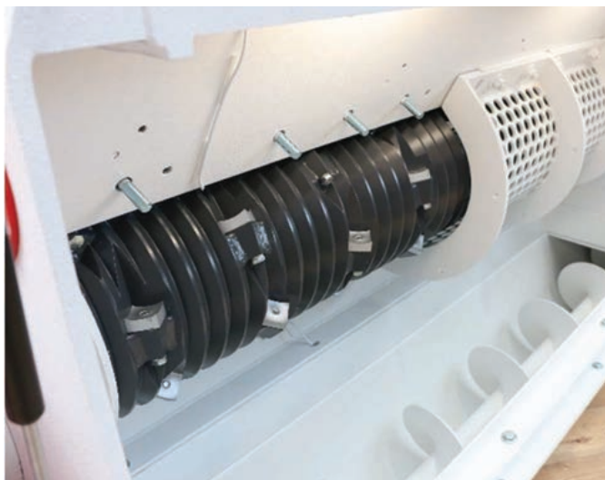
Профилированный ротор и режущие коронки одновального шредера
