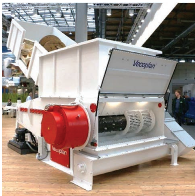
Шредер с вертикальной загрузкой материала
