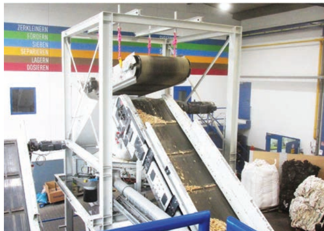
Сепарация металла из щепы
